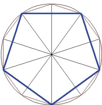
$\left(\frac{s_5}{2}\right)^2 = s^2 - \left(\frac{r-s}{2}\right)^2$ , da der Außenwinkel im Fünfeck  $54^\circ$  beträgt, somit die halbe Kantenlänge mit der Höhe bzw. Seitenhalbierenden im Dreieck  $\triangle RPQ$  (siehe oben in der Grafik zum regelmäßigen Zehneck) zusammenfällt und so die Strecke  $\overline{RP} = r-s$  halbiert.
